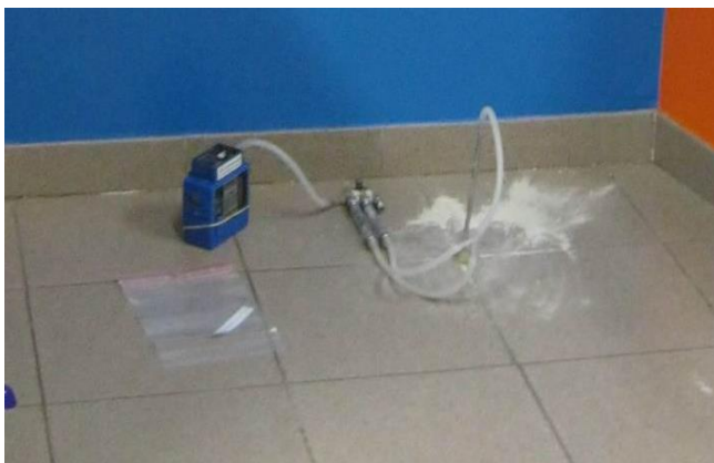
Prélèvement d'air sous dalle
